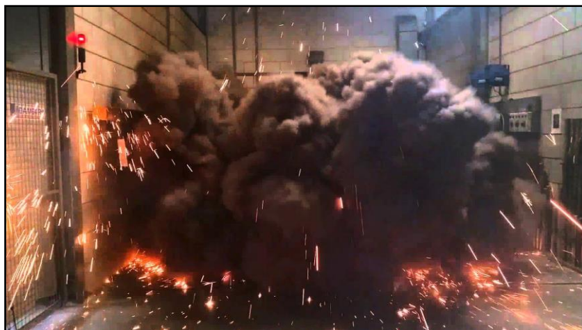
Obr. 4: Rozlet fragmentů a emise kouře při Acr-Flash [7].
