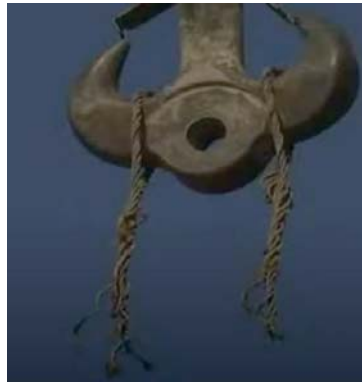
Obrázek 4: Pohled na přetržené vázací prostředky (ocelová lana). [1]
