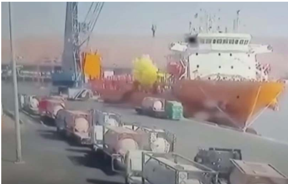
Obr. 2 Únik kapalného chloru bezprostředně po pádu přepravní cisterny na ložnou plochu lodi vzniklou rupturou. [8]
