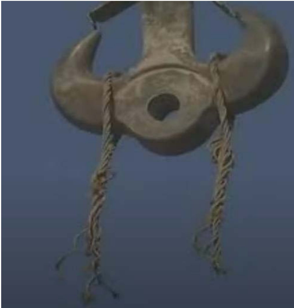
Obr. 6 Pohled na přetržené vázací prostředky (ocelová lana). [1]
